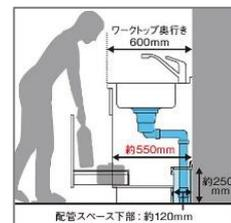
排水トラップから、キャビネット後方へ排水するバック排水となり排水管が収納の支障とならない為、従来より収納スペースが確保できます。
