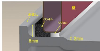
床の端に2mmの立ち上がりがあるため、お掃除によるシリコン劣化を抑制。
