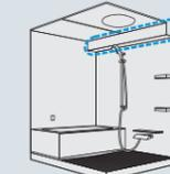
マンションによくある浴室の梁。工場梁欠き、現場での梁欠き対応が可能です。
