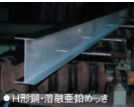
※梁に鋼材を使用する場合、等級3において、めっきの両面付着量はZ25(250g/㎡)同等以上と規定されています。※切断面は防錆塗装です。
