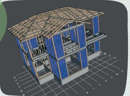
家の重さの中心(重心)と堅さの中心(剛心)のズレをチェック。ズレが大きい家はバランスが悪くなりがちで倒壊のリスクが高くなるので、ズレが許容範囲内か慎重に検定します。
