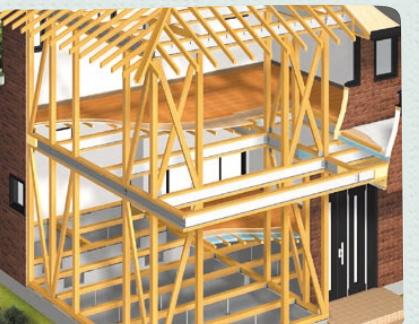
その家に、耐力壁(筋交いなどで補強した壁)がどのくらい必要か計算します。地震の揺れや強風など、水平の力に対する強さを検定します。
