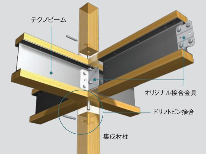
木と鉄の複合梁「テクノビーム」を採用。接合部も金具で強化し、ムクの柱\*1の約1.5倍の強度を持つ集成材柱\*2でさらに耐震性を高めています。
