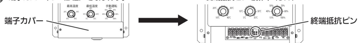
③ カバーを元に戻し、ネジ（2個）で固定する。
