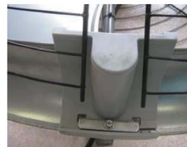
② ガードのフック部分にクリップを取り付け図のように、ベルマウスに差し込んでください。
