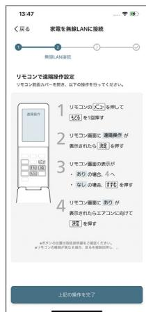
⑧リモコンの扉を開けて「メニュー」ボタンを「遠隔」が表示されるまで押し、「すすむ」ボタンを押して「遠隔 有」を選択しエアコンに向けて「決定」ボタンを押してください。
