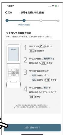
⑦リモコンの「無線LAN」ボタンを短く押し、「すすむ」ボタンを1回押して「L2」が表示されたらエアコンに向けて「決定」ボタンを押してください。
