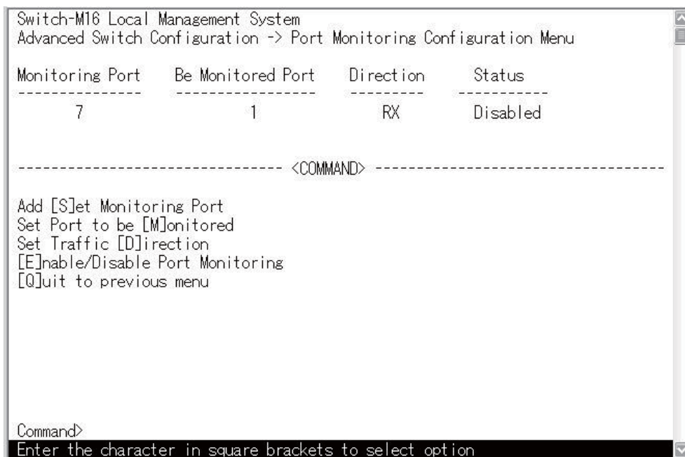
図4-27 ポートのモニタリング(Port Monitoring Configuration Menu)
