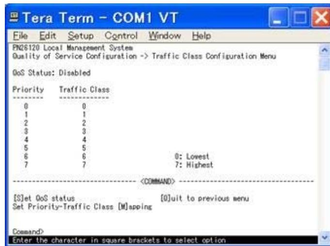
図4-7-19 トラフィッククラスの設定
