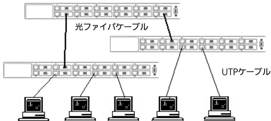
図3-2 光ファイバケーブル接続例
