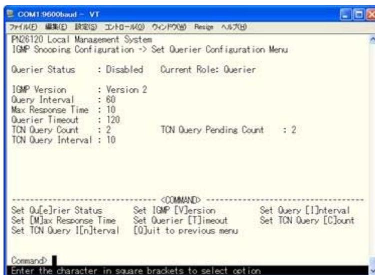
図4-7-44 IGMP Snooping Querierの設定
