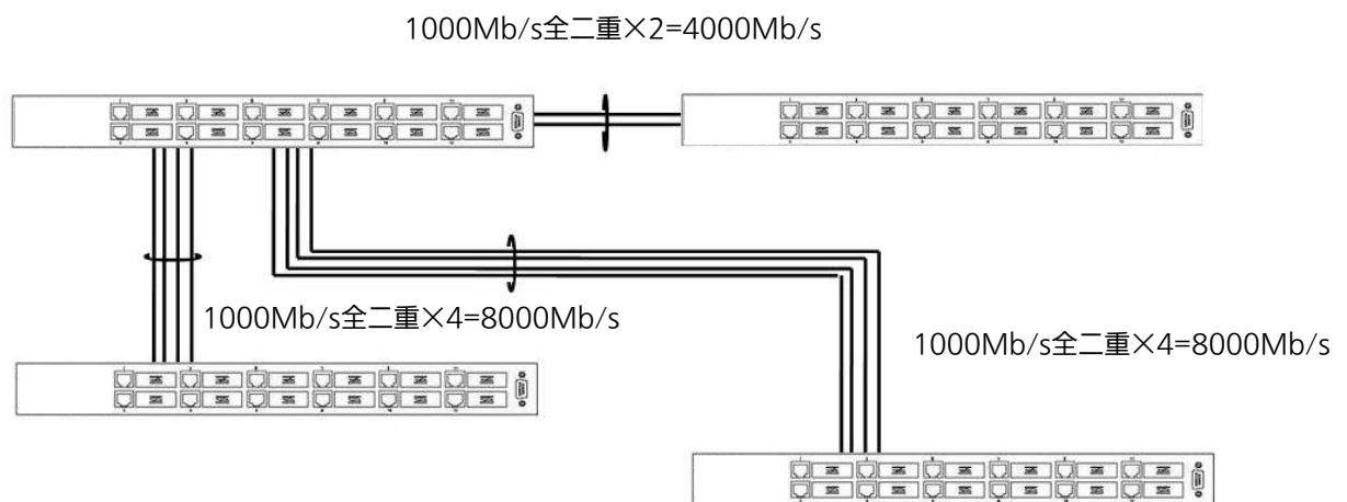
図4-7-7 トランкиングを用いた構成例2
