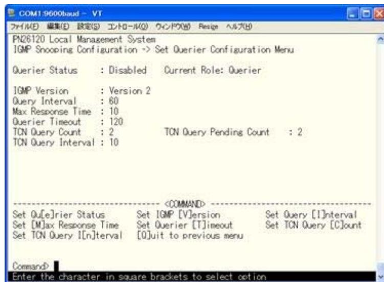
図4-7-44 IGMP Snooping Querierの設定
