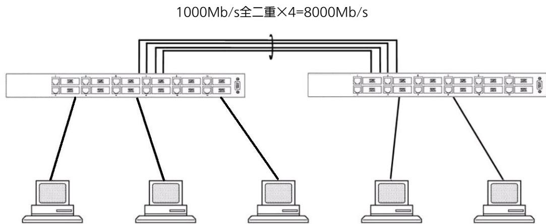
図4-7-6 トランкиングを用いた構成例1
