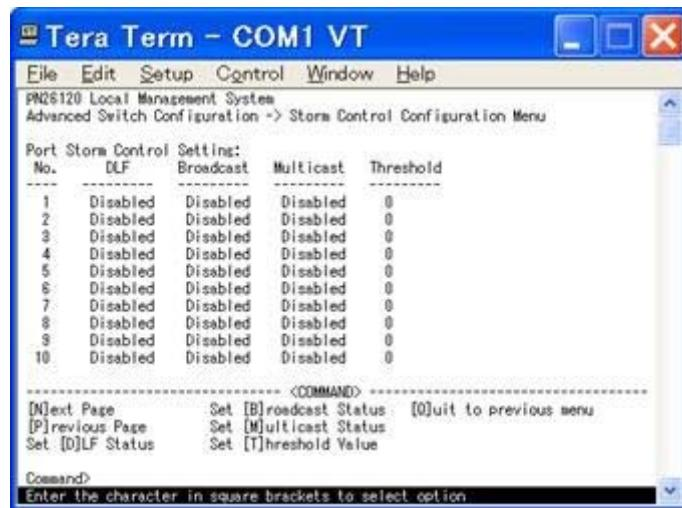
図4-7-32 ストームコントロールの設定
