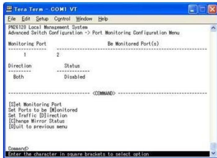
図4-7-11 ポートのモニタリング設定
