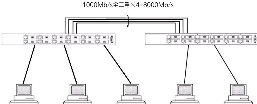
図4-7-6 トランキングを用いた構成例1
