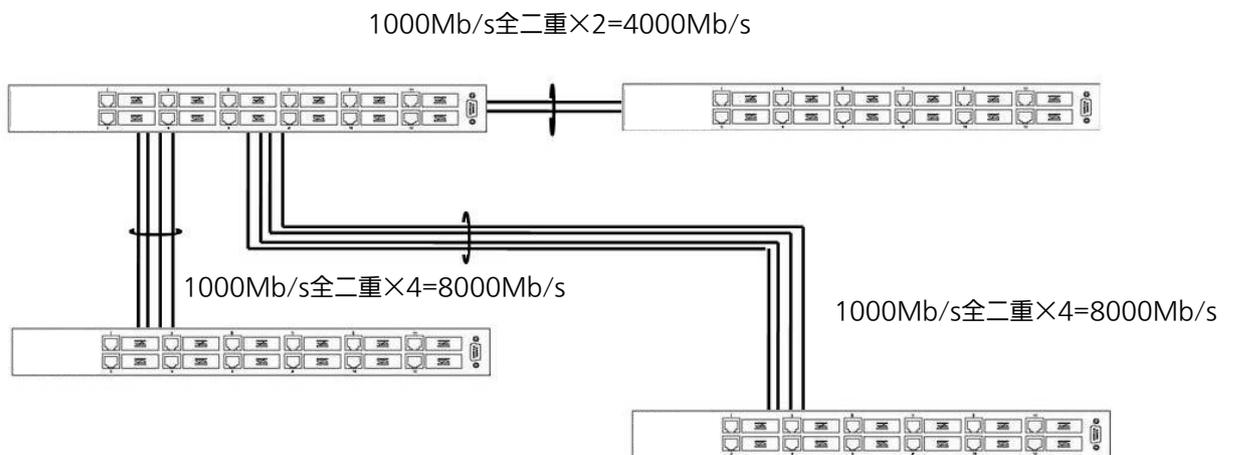
図4-7-7 トランキングを用いた構成例2
