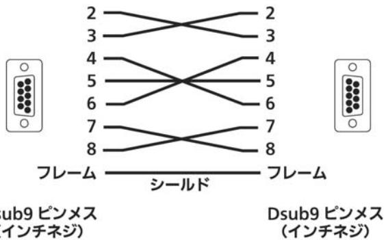
図A D-sub9ピン - D-sub9ピン コンソールケーブル結線仕様
