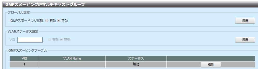
IGMP を有効にする各 VLAN を表示します。
