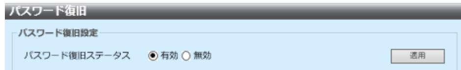
これを有効にすると、デバイスのコンソールポートへの物理アクセス権限を持つエンドユーザはブートメニューに入りパスワード復旧プロセスをトリガできます。システムの起動が終わると、パスワード認証なしにデバイスにログインできます。デバイスにログインするのは、コンソール経由でのみ、コンソールが物理アクセスによってデバイスに接続されている場合に限り許可されます。
