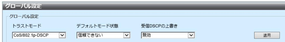
デバイスが拡張モードの場合、[トラストモード] を設定します。パケットの CoS レベルおよび DSCP タグが別々のキューにマッピングされている場合、設定する信頼モードによってパケットがどのキューに割り当てられるかが決まります。
