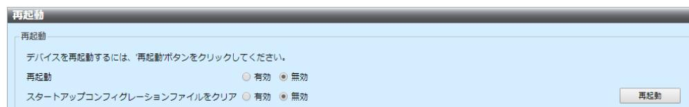
[ 工場出荷時のデフォルトに戻す ][ スタートアップコンフィグレーションファイルをクリア ][ 再起動 ] フィールドのうち、一つを有効にし [ 再起動 ] ボタンを押すと、デバイスを再起動します。
