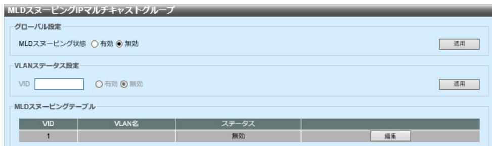
[[MLD スヌーピング](#)] がグローバルで有効の場合、ネットワークトラフィックをモニタリングするデバイスは、どのホストがマルチキャストトラフィックの受信を要求したかを判定できます。デバイスは、MLD スヌーピングとブリッジマルチキャストフィルタリングの両方が有効な場合に限り、MLD スヌーピングを実行します。
