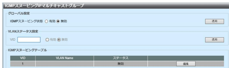
[IGMP スヌーピング] の [IGMP スヌーピング状態] が有効の場合、ネットワークトラフィックをモニタリングするデバイスは、どのホストがマルチキャストトラフィックの受信を要求したかを判定できます。デバイスは、IGMP スヌーピングとブリッジマルチキャストフィルタリングの両方が有効な場合に限り、IGMP スヌーピングを実行します。
