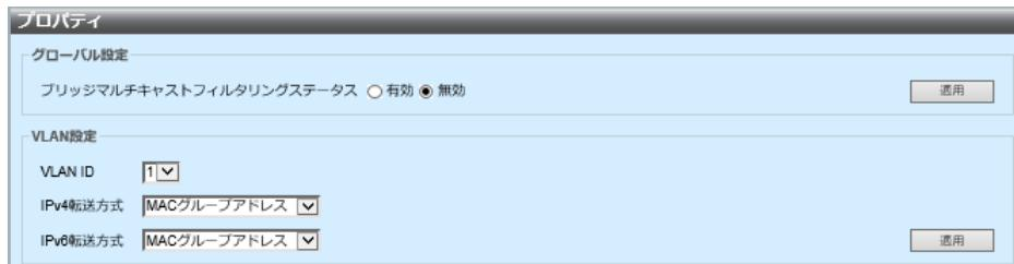
[ブリッジマルチキャストフィルタリングステータス] を設定しフィルタリングを有効にします。
