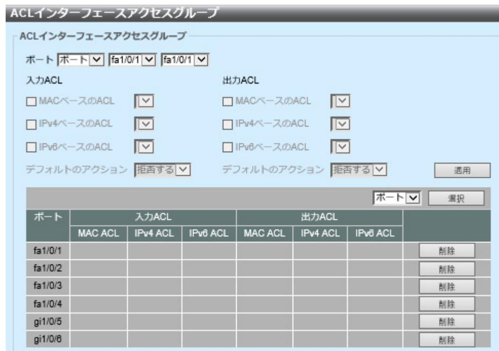
設定したインターフェースのタイプに応じて、そのタイプのすべてのインターフェースと、各インターフェースに現在バインドされている入力 ACL/ 出力 ACL のリストが表示されます。
