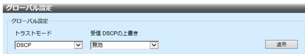
デバイスが基本モードの場合、[ トラストモード ] を設定します。パケットの CoS レベルおよび DSCP タグが別々のキューにマッピングされている場合、設定する信頼モードによってパケットがどのキューに割り当てるかが決まります。
