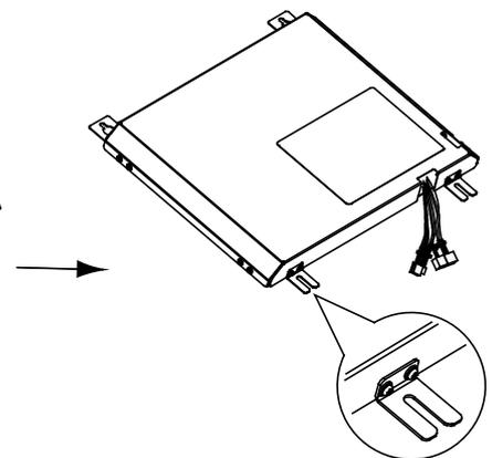
バッテリーユニットとL字金具の底面を揃え平行に取付ける
