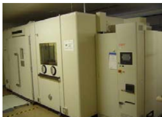
恒温槽を高効率タイプへ切替
