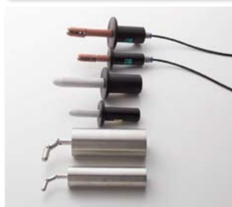
様々な疑似指モデルによる評価(2009～) Various artificial finger models
